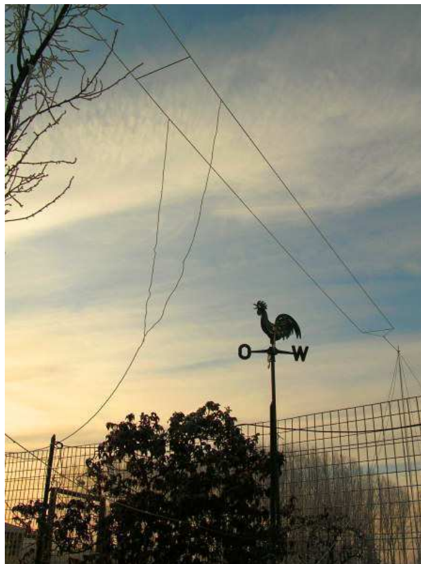
Una delle antenne utilizzate per la ricezione delle emissioni dirette ai sottomarini, delle risonanze di Schumann e nello studio dei precursori radio sismici: una Marconiana alta 11 metri e lunga 45..
